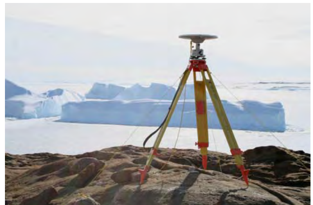
写真-9 露岩域でのGPS観測
