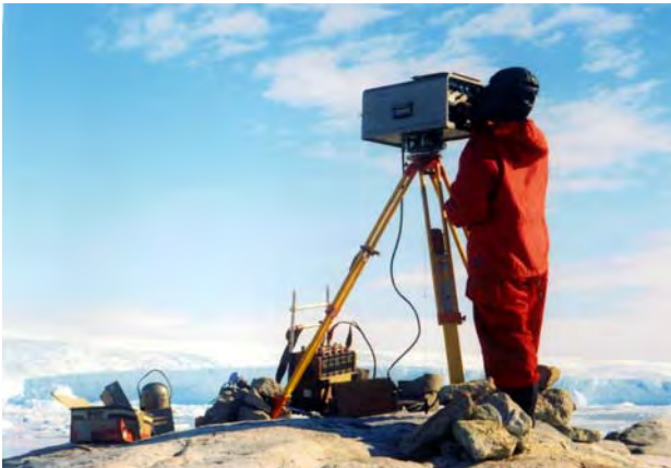
写真-4 ジオジメータ 8 型による観測 (第 14 次観測隊)
