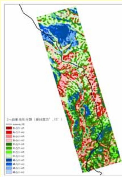
2mグリッドの自動地形分類 (12分類, 傾斜度15°,35°で区分)
