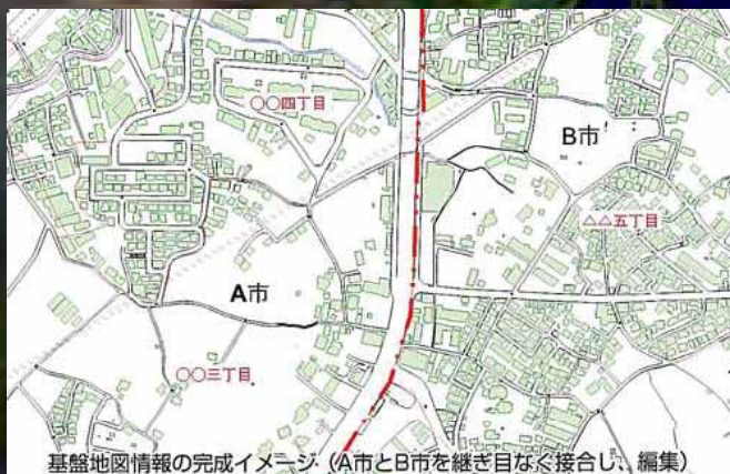
基盤地図情報の完成イメージ (A市とB市を継ぎ目なく接合し、編集)
