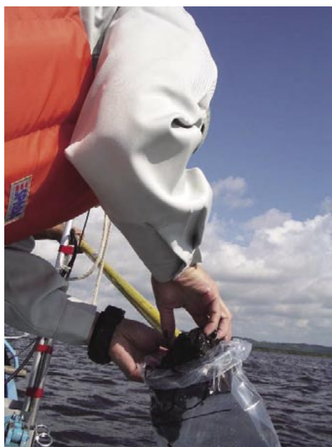
写真-7 槍式採泥器による底質採取
