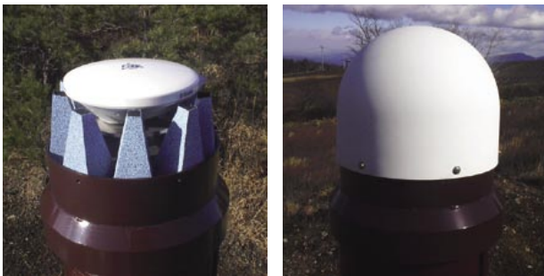
左：アンテナ 右：レドーム 写真-3 アンテナ架台上部
