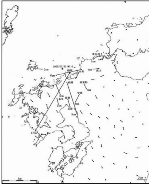
図-2 電子基準点の地殻水平変動ベクトル
