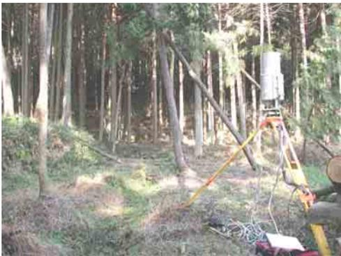
図16 地上型レーザスキャナ計測作業風景写真
