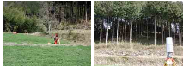
図 2 0 検証箇所と地上設置型レーザースキャナー
