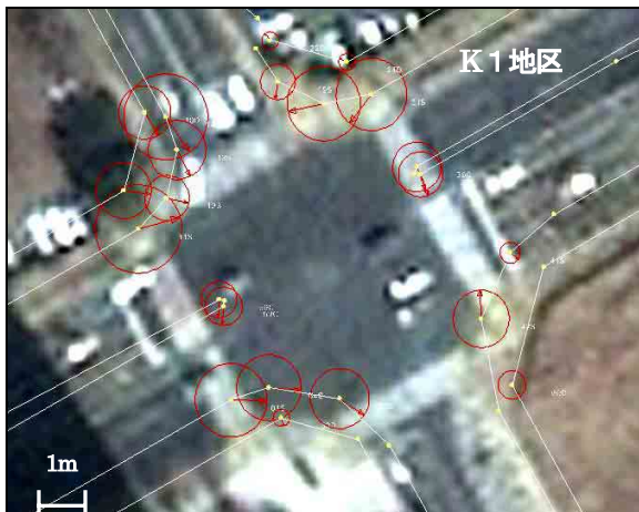
図13 GCP計測と図化単点のズレ(つくば市街地交差点)
