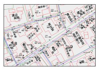
美濃加茂市給水戸番図データの基図は 1/500 精度であるが、道路や建物など地形についての住宅地図データとのズレは、1/500 に印刷した図上で、平均 3mm から 5mm程度、最大 9mm から 12mm であった。また、給水施設については、概ね適当と思われる位置に表示されていると思われた。
