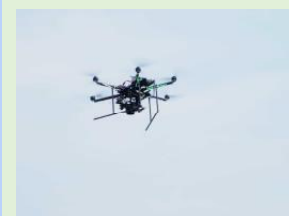
UAV (ドローン) 回転翼によるレーザ測量
