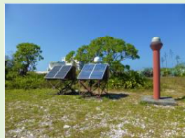
日本最東端 電子基準点「南鳥島」
