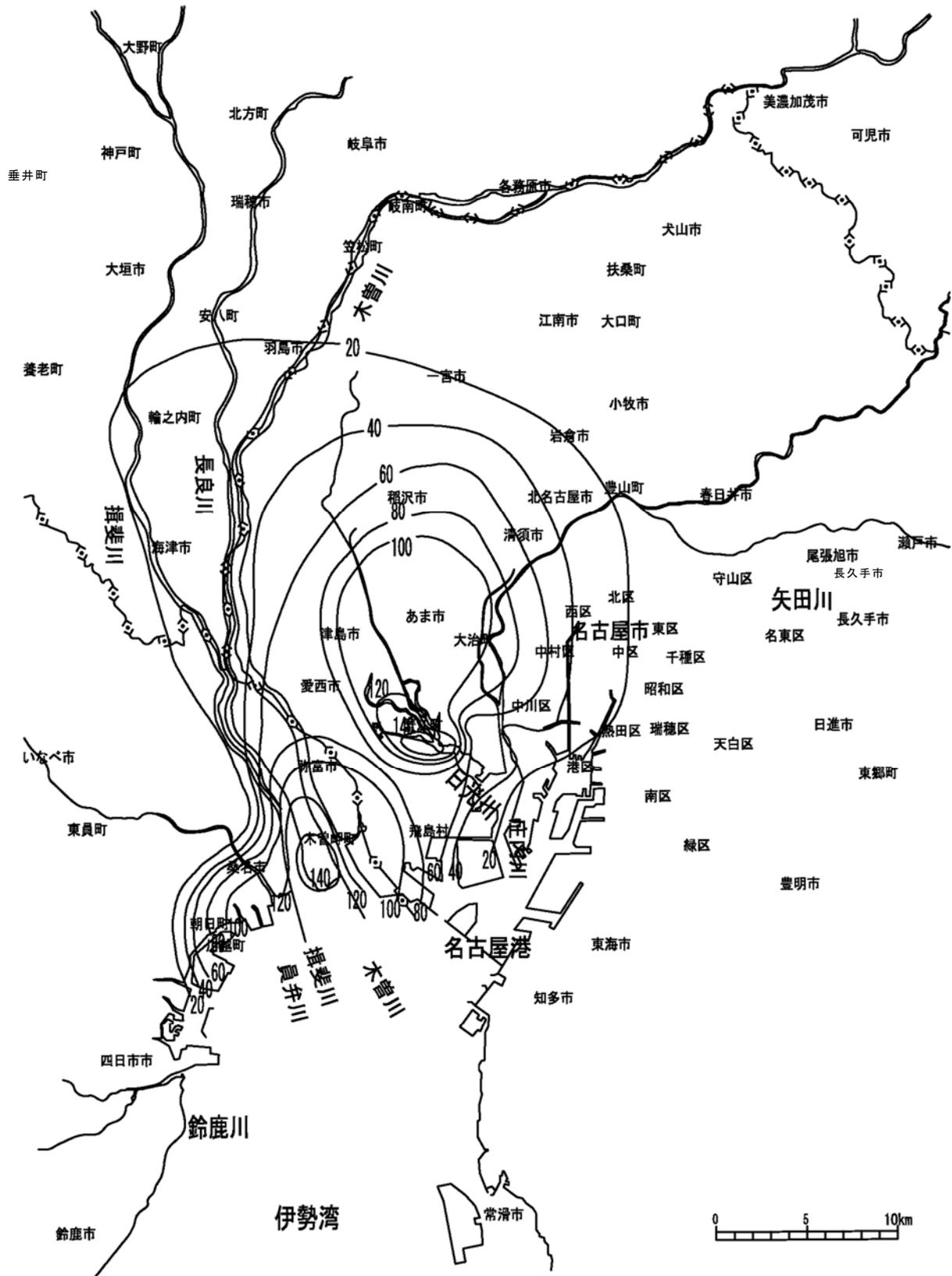
図－3 昭和36年以降の累積沈下量等量線図（単位：cm）
