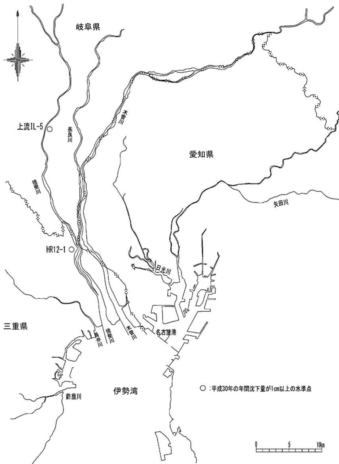
図ー2 平成30年度における年間沈下量1cm以上の水準点位置
