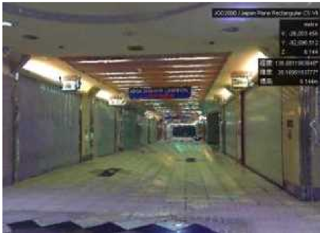
高密度三次元点群データによる地下街エスカの再現 ((株) きもと製点群ビューワー「GEOVERSE」を使用)
