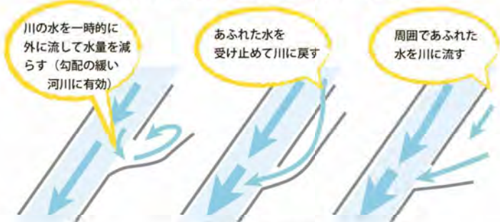
図2-2 霞堤の仕組み
