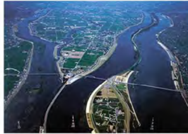
写真 2-4 木曾三川流域の輪中地域 (国土交通省中部地方整備局河川部より引用) 洪水被害を防ぐため、集落全体を堤防で囲んでいます。このような地域を「輪中」といいます。
