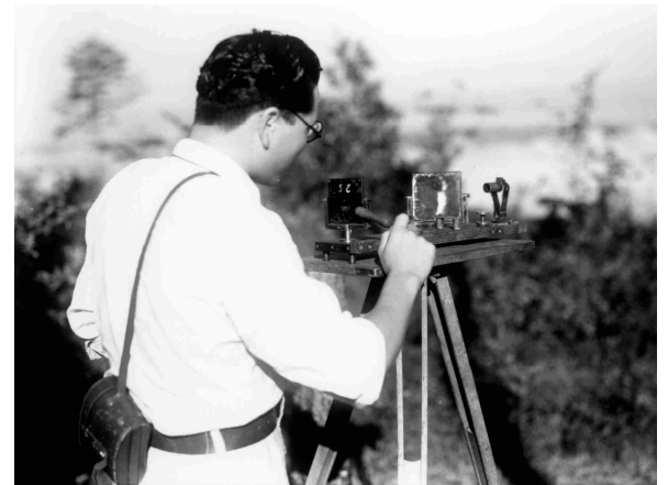
回照器 太陽の日週運動に合わせて鏡の向きを調整します
