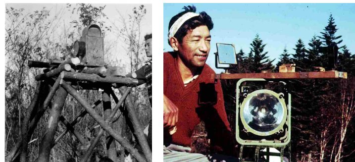
回光灯 左：カーバイト使用、右（回照器の下）：電球使用
