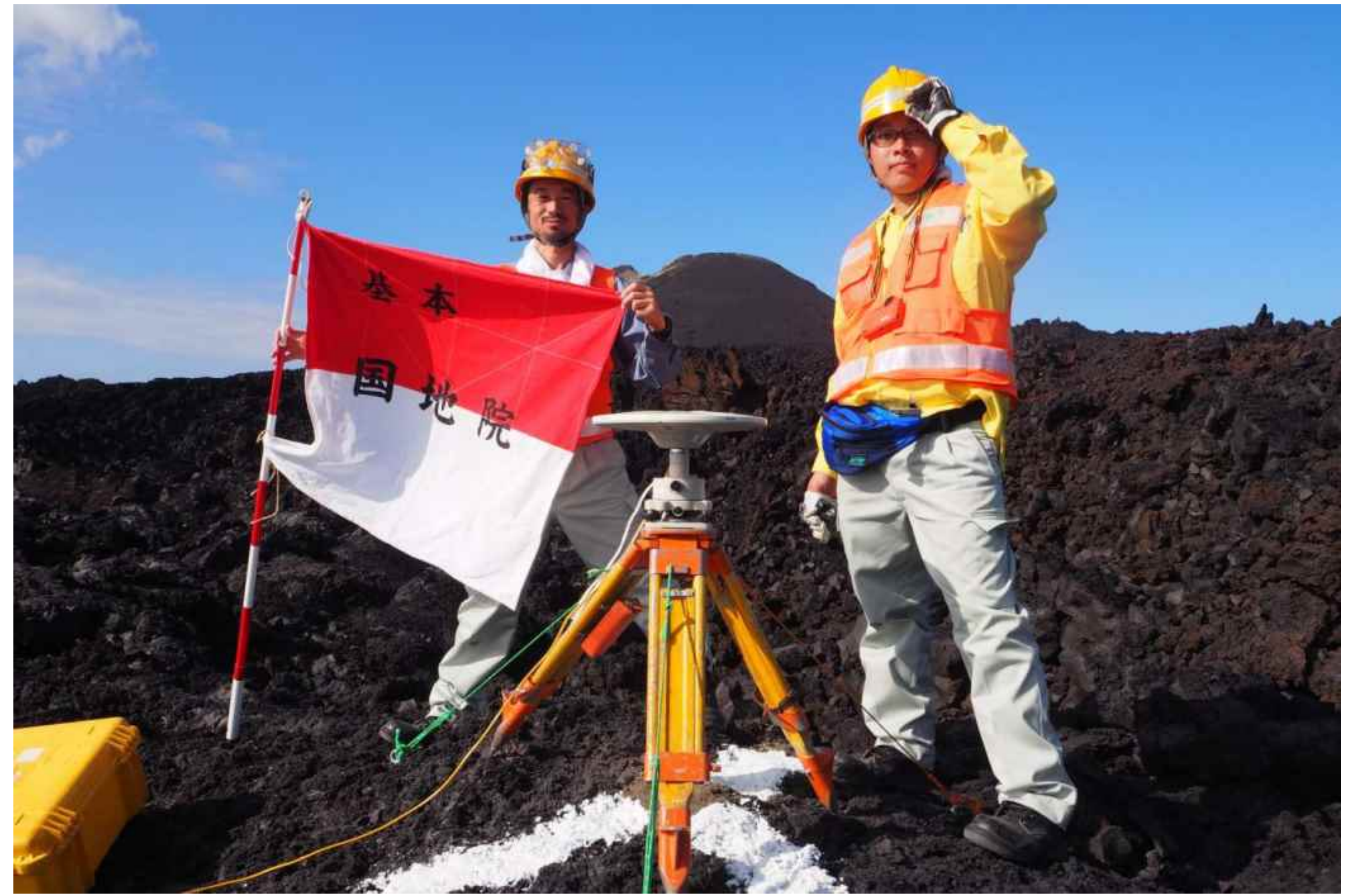
「三等三角点設置完了」
