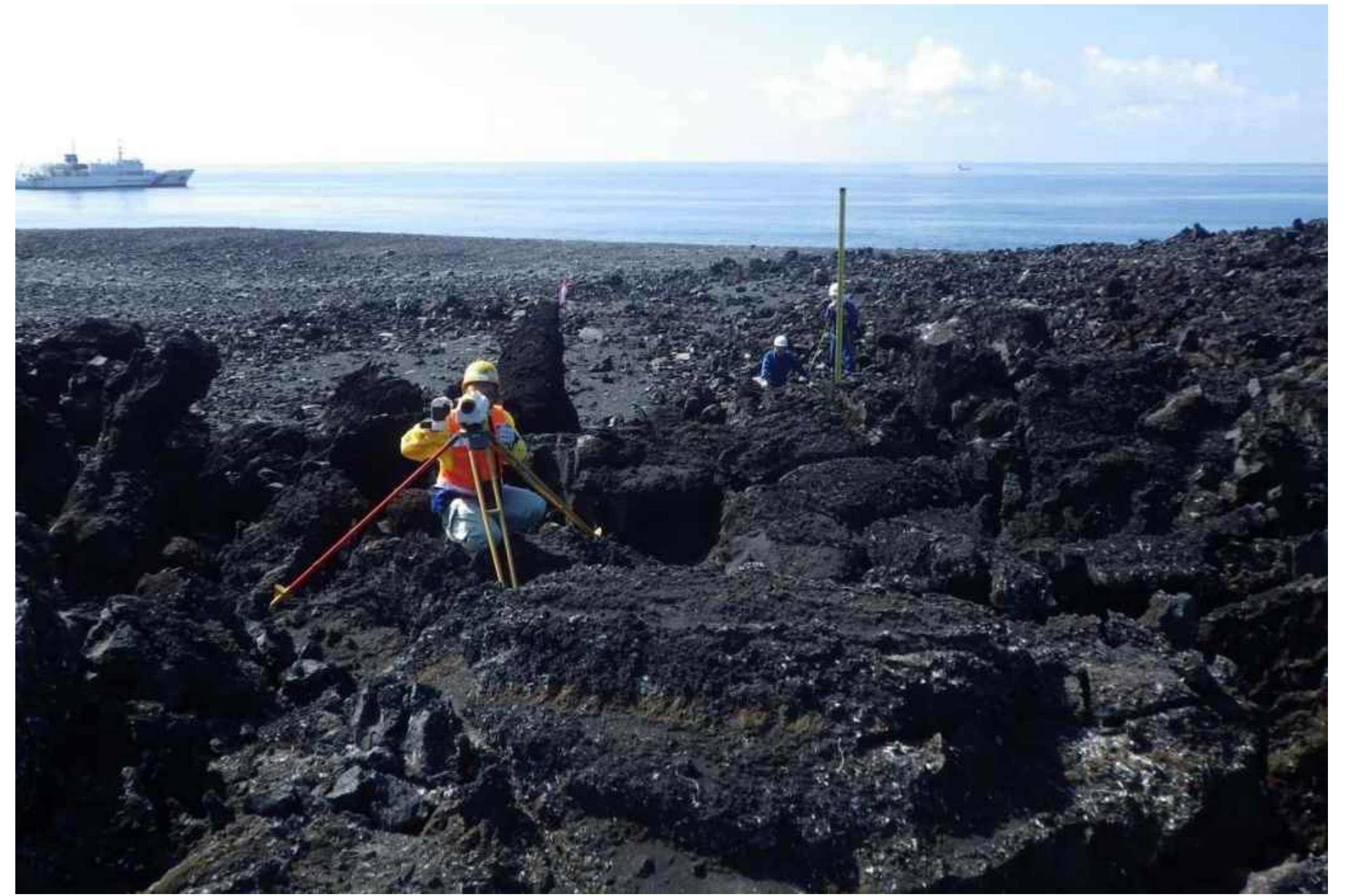
「足場の悪い溶岩上での水準測量」
