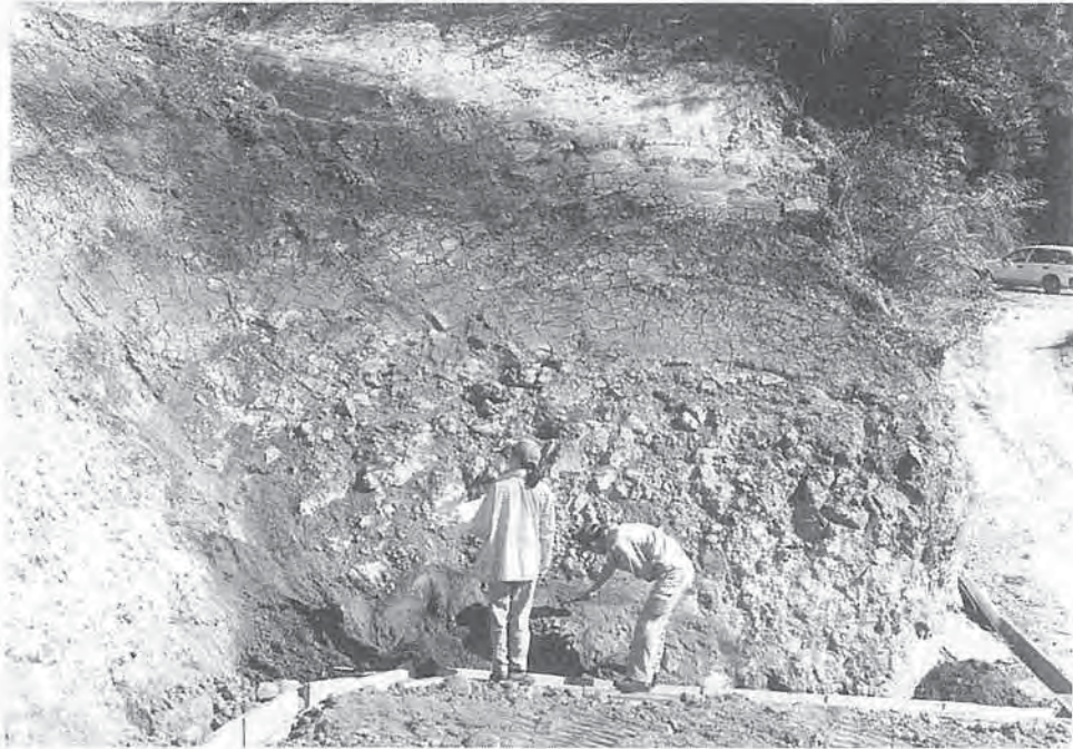
写真9 烏帽子岳西麓の古い扇状地。下位に扇状地砂礫層、上位にテフラ。上位のテフラ中にはアカホヤ火山灰、牛のすね火山灰などが見られる。(牧園町大瀬戸)
