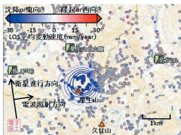
図-7 大分県九重山におけるPSI局所解析の結果. 黄緑色印は気象庁が設置したGNSS観測点を表す.
