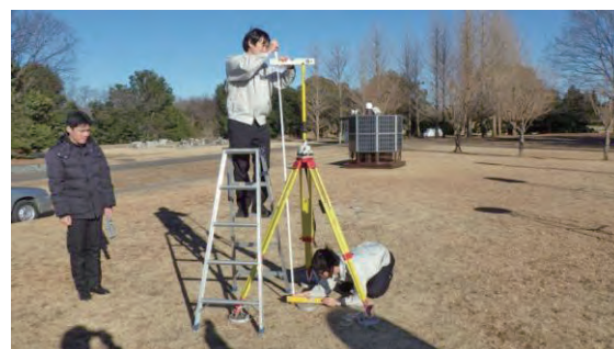
写真-1 アンテナ高測定の実験風景
