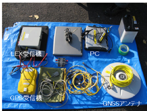
図 3-2 QZS-QS 法の観測機器構成と観測風景
