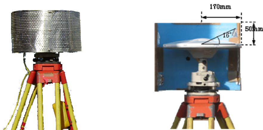
図 3-35 アマチュア無線との干渉対策のアンテナシールド
