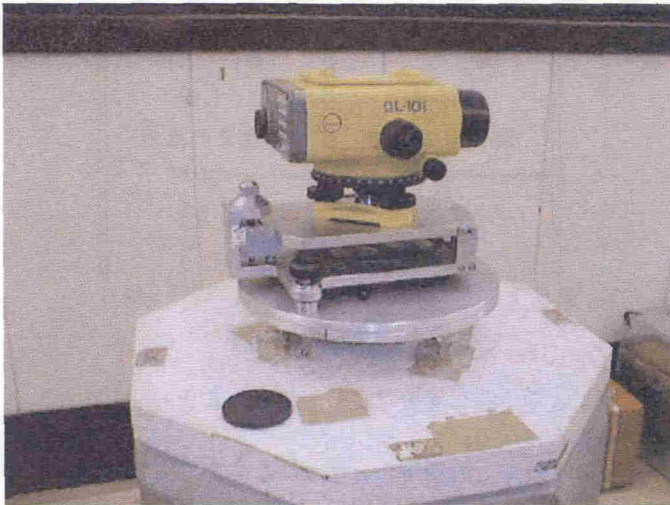
写真-4 傾斜計を使用したコンペンセータのテスト
