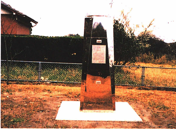
写真-1 高精度比高観測点のアンテナ架台
