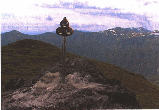
再設置したAPS反射点(1999年6月) (ステンレス製台座を用いて岩に固定した例)
