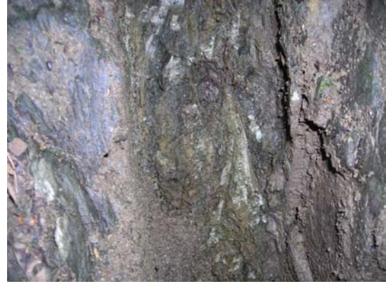
⑧地点の直下の断層破碎帯 (断層粘土や鏡肌を確認できる)
