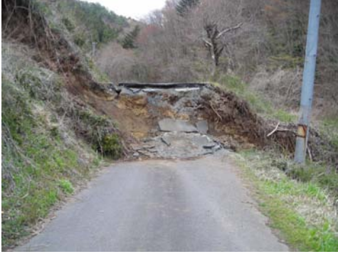
写真1 塩ノ平の断層露頭（段差は2m程度）
