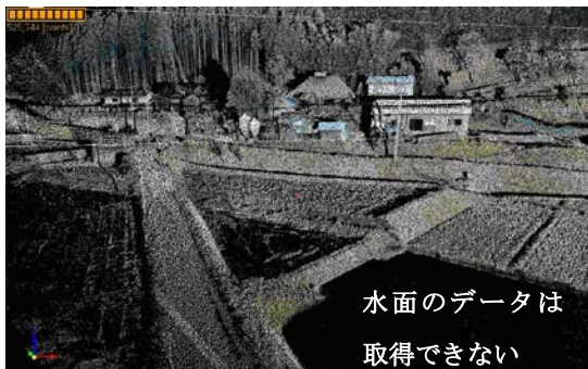
樹木除去処理前の水田付近データ
