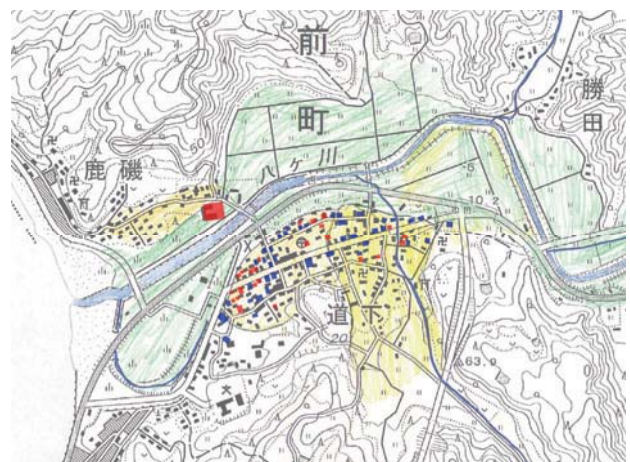
図-14 輪島市門前町道下地区における家屋の倒壊分布 (赤：全壊、青：一部破損)
