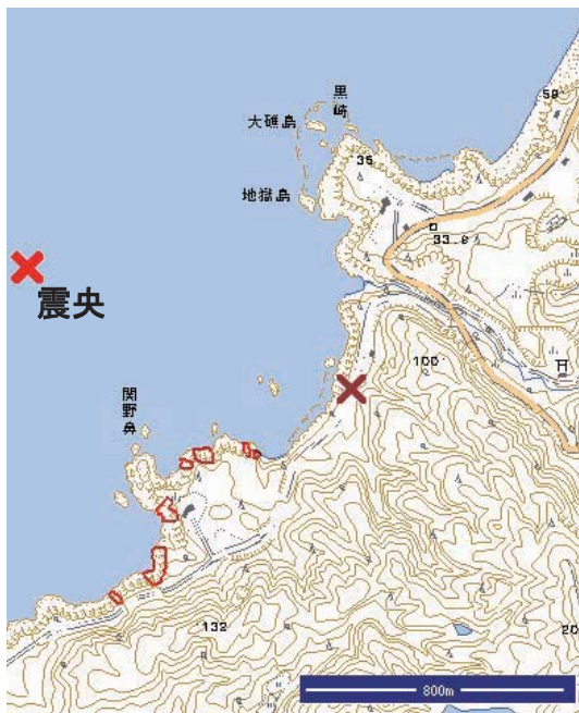
(a) 海食崖・海成段丘面と崩壊位置
