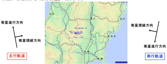
地表の変動は三次元(東西、南北、上下)ですが、SARで観測できるのは、衛星視線方向の1方向しかありません。つまり、1つのSAR干渉画像からは、地表が衛星に対して(近づく、遠ざかる)の一方向の変動量のみが判ります。そのため、北行軌道と南行軌道の観測では、同じ変動を捉えた場合でも、違って見えることがあります。
