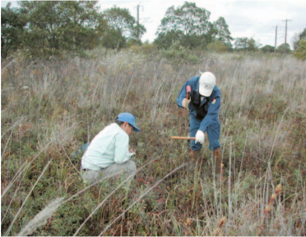
写真-2 簡易ボーリング調査
