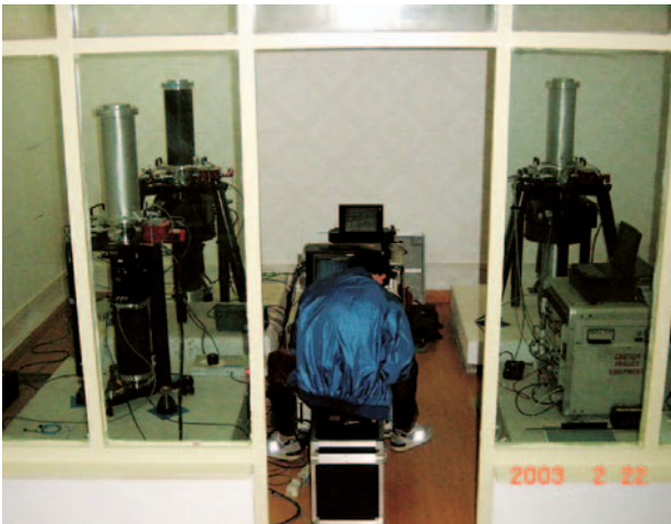
写真-9 CAS/IGG (右), 地理院 (左奥), 京大 (左手前) のFG5 3台による比較観測
