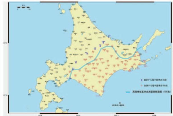
図一 13 電子基準点・三角点の成果改定予定地域。ただし、計算の結果、地域が変更される可能性もある。
