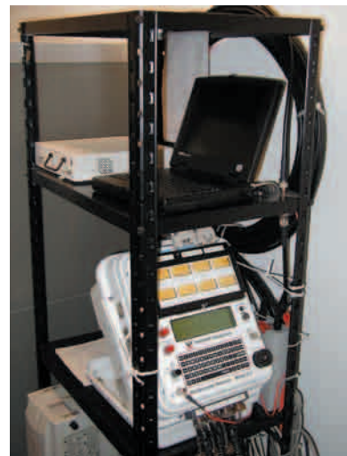
写真-2-2 江刺観測場施設内に設置しているV5本体（下部）と、データ取得用のパソコンおよび外付けハードディスク（上部）
