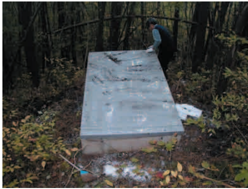
写真-1-1 江刺観測場構内の磁場センサーコイルを埋設しているピット
