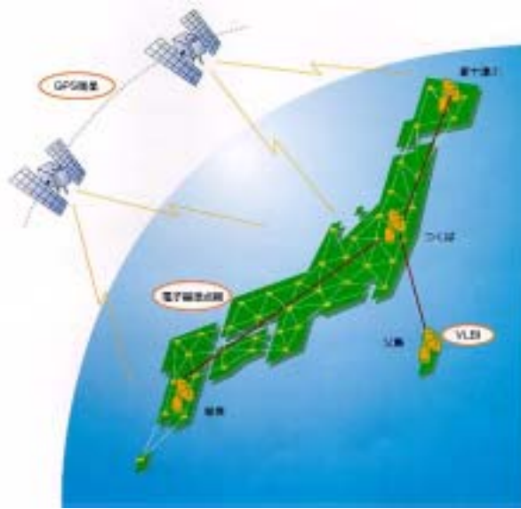
図-2 宇宙測地技術に基づいた測地系 世界測地系への移行時には、VLBI 観測局による成果を元に、全国の電子基準点 (GPS) を用いて計算を行っている。
