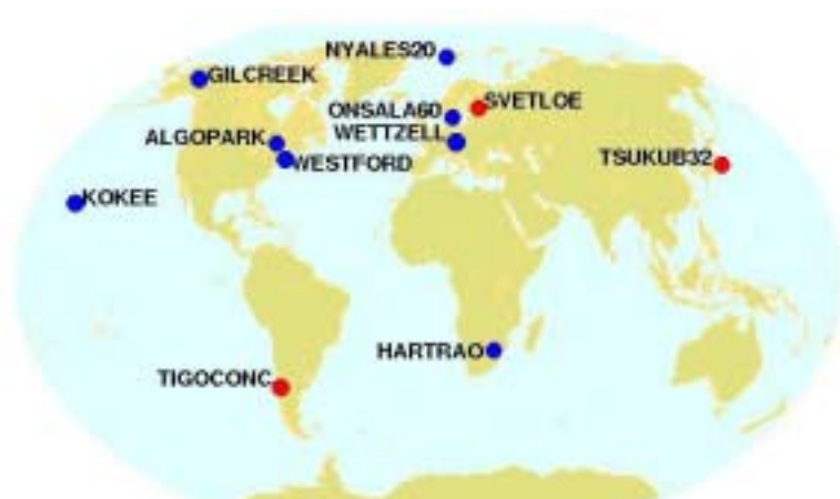
図-7 CONT02 参加局 (青丸), CONT05 参加局 (青丸+赤丸) 前回のCONT02 (2002 年実施) の参加局 (8 観測局) と比較し, 観測局数が増え, 地球全体をカバーする観測網となっている. より高精度な観測結果が期待できると共に, つくば観測局はアジア・オセアニア地域唯一の観測局として, 重要な役割を担った.
